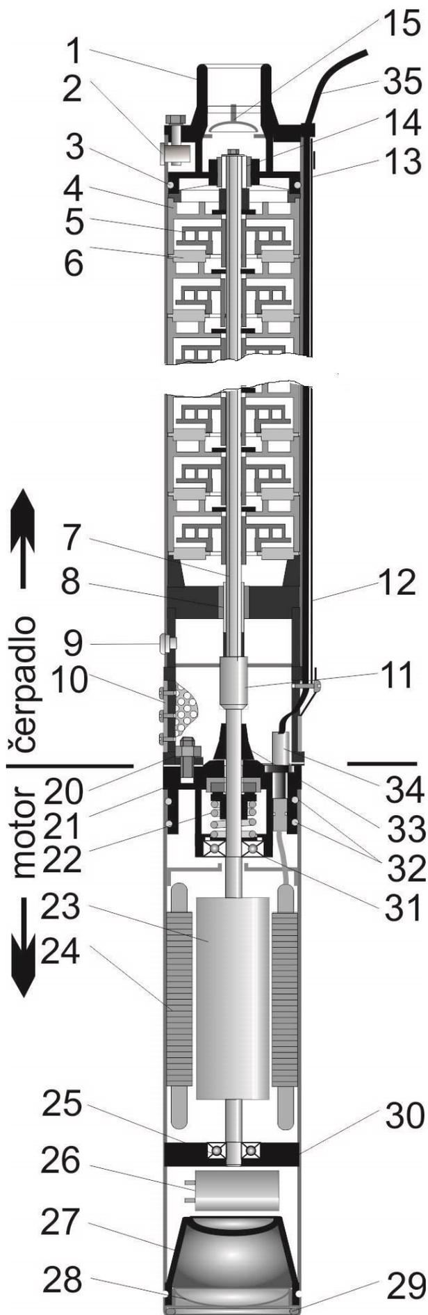
1. ložisková podpěra horní s výstupním hrdlem 1,5"
