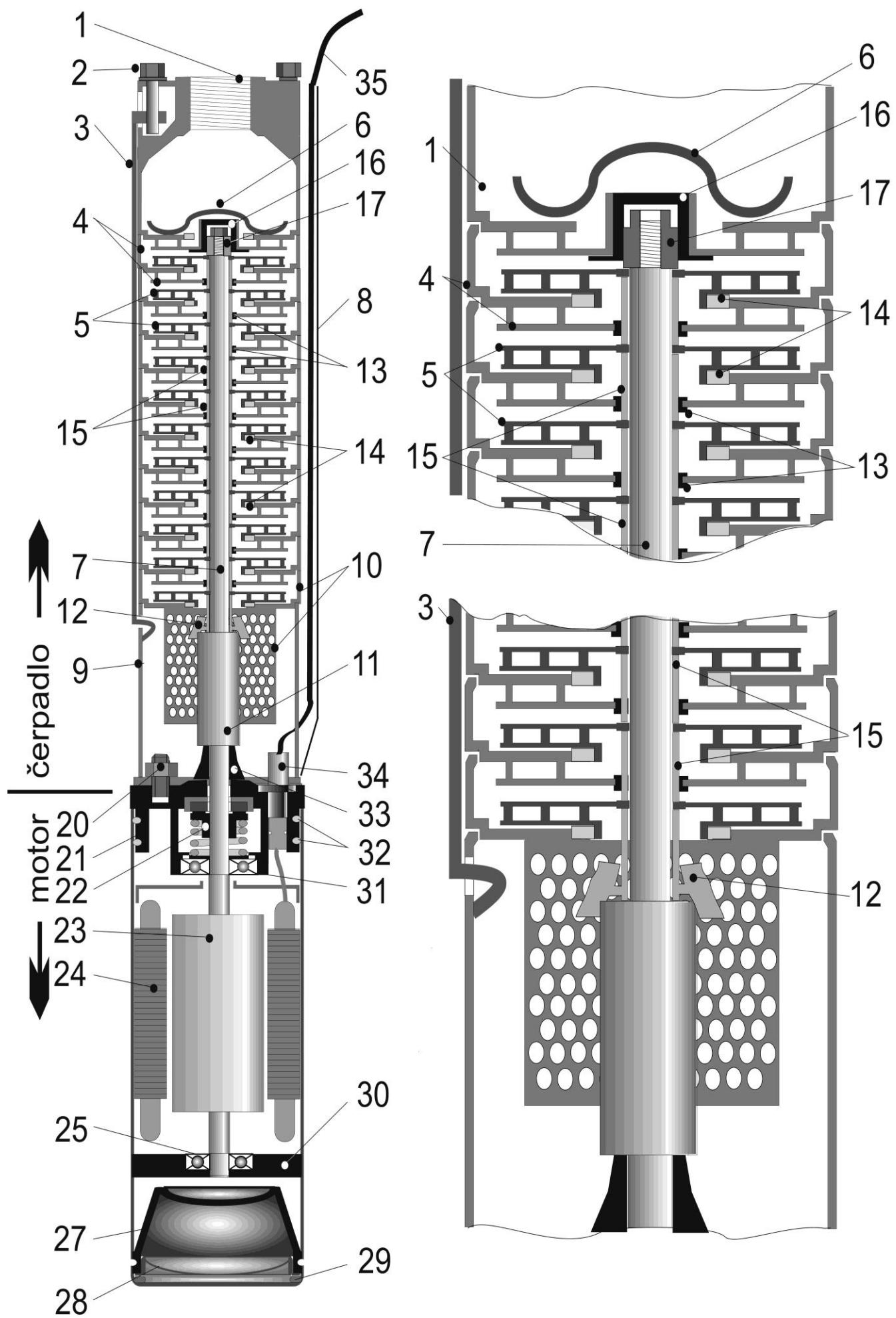
**Detail statorového článku s difuzorem kompletního:**
